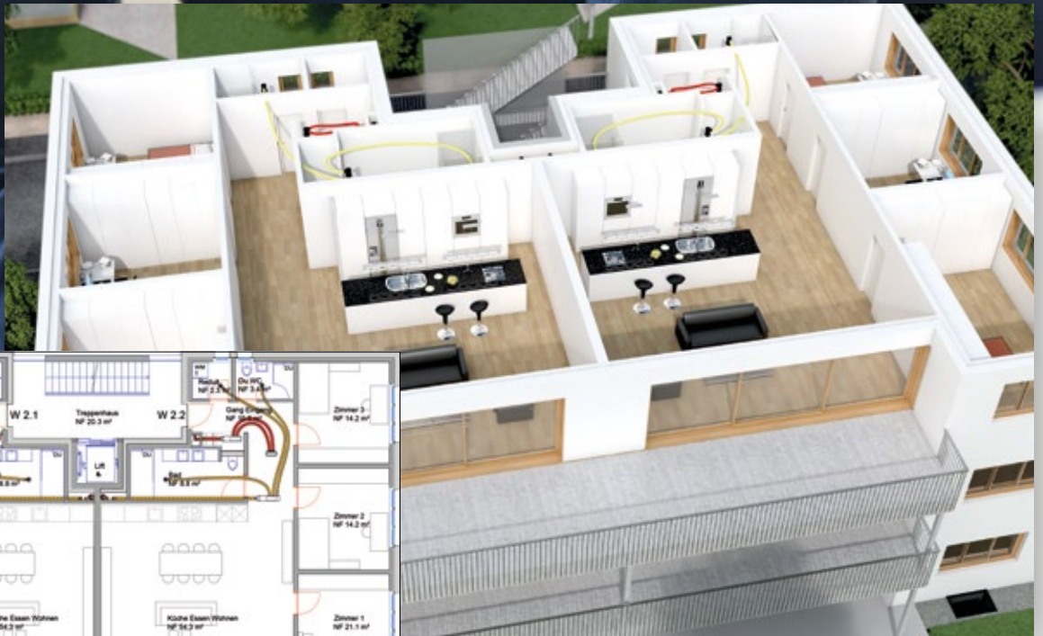
Une ventilation de base permet d'amener en permanence de l'air frais à plusieurs logements – avec récupération de la chaleur (et récupération de l'humidité en option)
