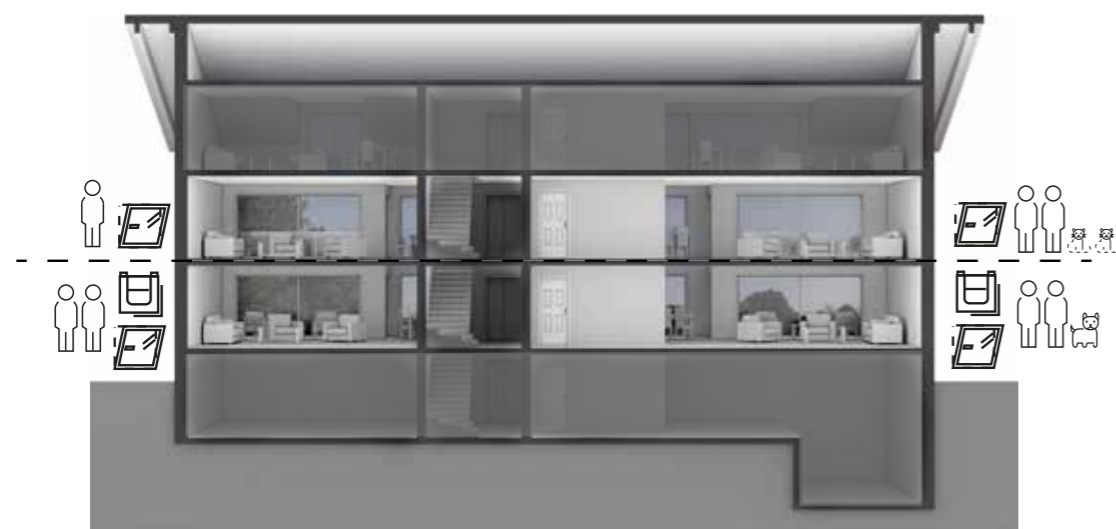
Abbildung 1: Gebäudeplanansicht mit Familiengröße und Lüftungsart.
