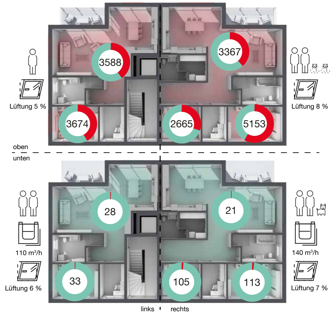
Abbildung 5: Grundriss des Gebäudes mit der Anzahl der überwachten Stunden mit CO 2 -Werten über 1 000 ppm. Lüftungsfaktor auf Basis des Gesamtjahrs.
