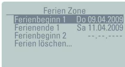
2. Durch Drehen des Scrollrads **Ferienbeginn** des einzustellenden Ferienblocks markieren und durch Drücken der **enter**-Taste auswählen.
