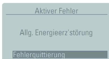
Fehlermeldung von der Aussen-Wärmepumpe
