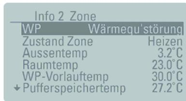
Strömungswächter hat angesprochen (Durchfluss zu niedrig, Pumpe defekt)
