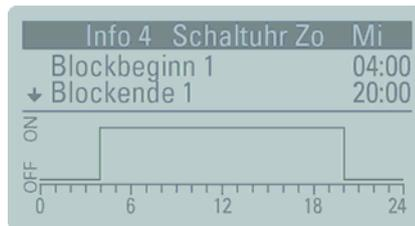
Die Grafische Darstellung der Heizzeiten dient der schnellen Übersicht der eingestellten Blöcke (pro Tag sind 6 Schaltpunkte paarweise programmierbar). Die Beschriftung ON entspricht der Zeit bei welcher auf den Sollwert **Normal**, die Beschriftung OFF bei welcher auf den Sollwert **Reduziert** resp. **Frostschutz** geregelt wird.
