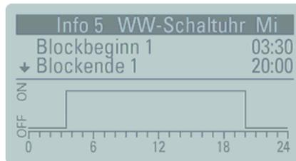
Die Grafische Darstellung der Heizzeiten für das Warmwasser dient der schnellen Übersicht der eingestellten Blöcke (pro Tag sind 6 Schaltpunkte paarweise programmierbar). Die Beschriftung ON entspricht der Zeit bei welcher auf den Sollwert **Normal**, die Beschriftung OFF bei welcher auf den Sollwert **Reduziert** resp. **Frostschutz** geregelt wird.
