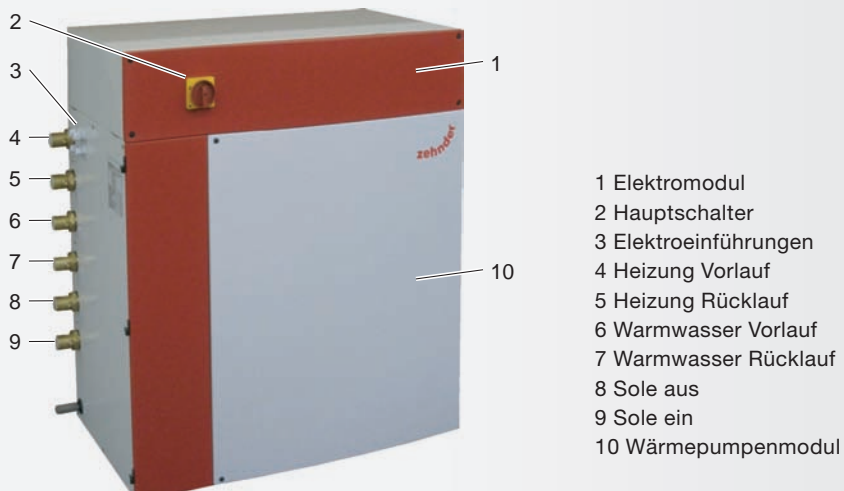
Fig. 2 Aufbau Zehnder Wärmepumpe
