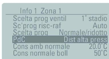
Pressione nel circuito di raffreddamento eccessiva (condensatore):
