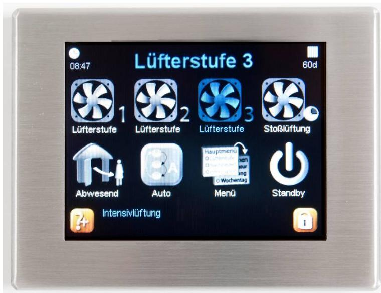
Bild 4: TFT-Touchpanel im Edelstahlrahmen
