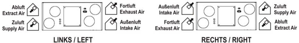
Bild 24: Aufkleber Anschluss Luftleitungen
