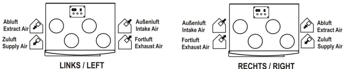
Bild 22: Aufkleber Anschluss Luftleitungen
